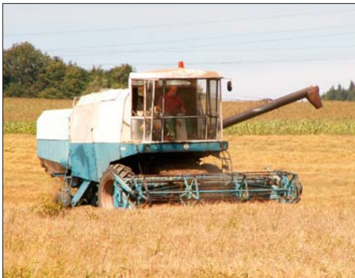
Takýto kombajn 1 hektár obilia pokosí a súčasne vymláti v priemere za 2 – 3 hodiny.
